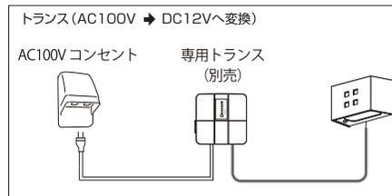
※地中、壁面への配線の場合は、ライトの電源コードを電線保護管(市販品)に必ず通し、不乾性パテ(市販品)で止水処理を行ってください。
