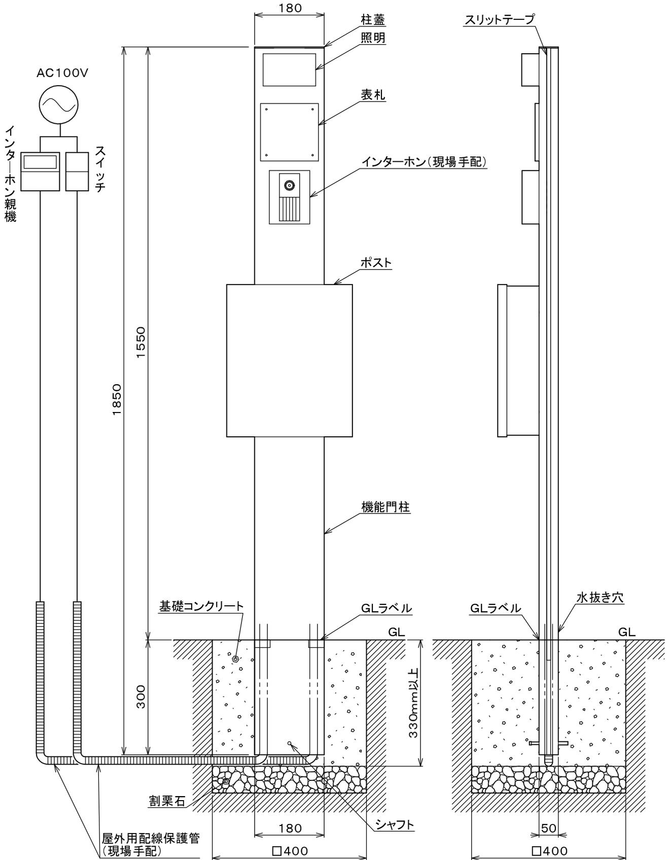
※上図の基礎の寸法は参考値です。施工現場の地盤強度によっては基礎の寸法を変更してください。
