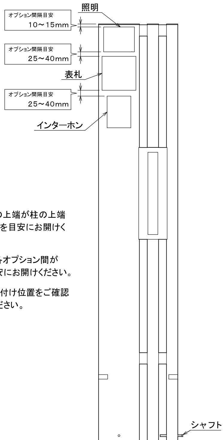
※ 照明の取付穴の位置は、照明の上端が柱の上端から10mm～15mmとなることを目安にお開けください。
