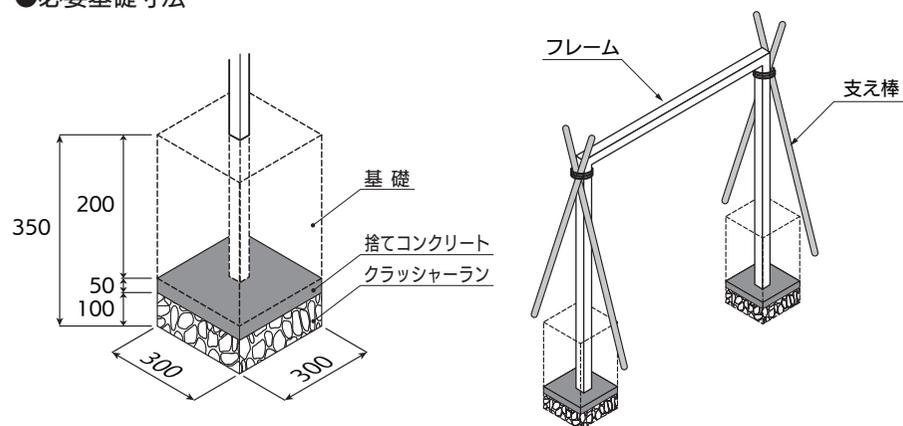
※複数フレームを施工する場合、フレーム間の幅は、80mm以上を推奨いたします。現場に合わせて施工してください。
