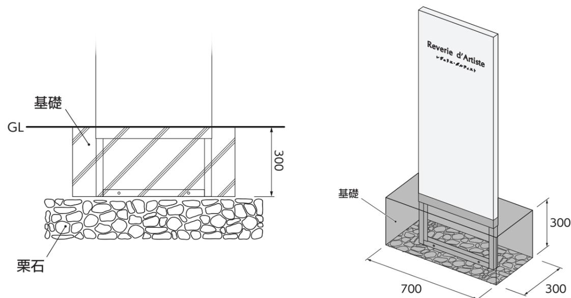
※上記の基礎の寸法は参考値です。施工現場の地盤強度によっては基礎の寸法を変更してください。
