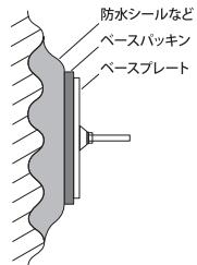
取付面に凸凹がある場合は、防水性能を保つため、防水シールなどで器具と取付面とのすき間を埋めてください。
