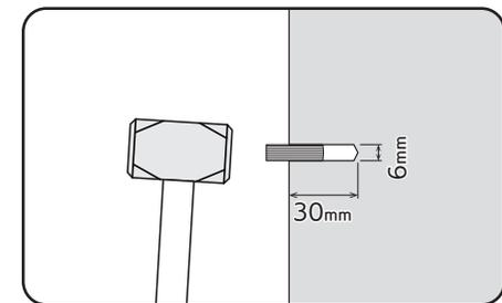
壁面に直径Φ6mm、深さ30mmの下穴をあけ、切粉等を除去し、下穴にカールプラグを打ち込んでください。
