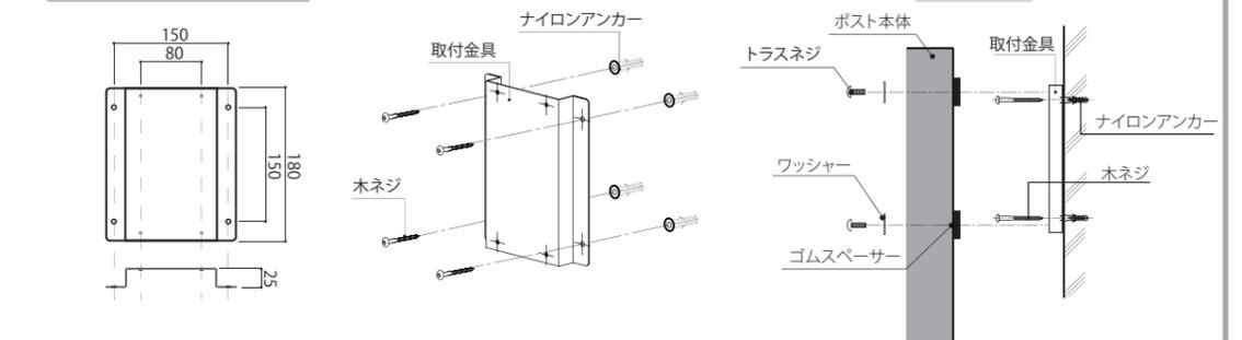
**2** ポスト内側背面から、トラスネジとワッシャーで取付金具に取付けます。
