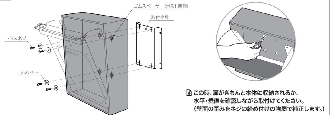
この時、扉がきちんと本体に収納されるか、水平・垂直を確認しながら取付けてください。(壁面の歪みをネジの締め付けの強弱で補正します。)
