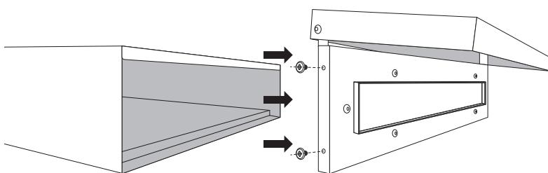
●投函蓋・金口部分を手前方向に外します。
