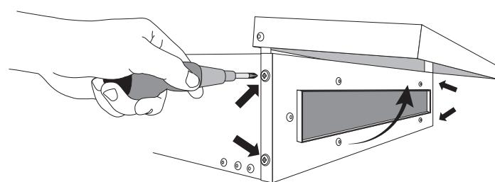
●投函蓋を開けて、金口両サイドのねじ(4箇所)を外します。
